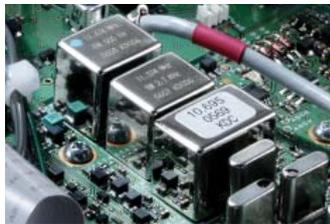
\*Para bandas Amateur 1.8/3.5/7/14/21 MHz, en modos recepción CW/FSK/SSB la conversión inferior es automáticamente seleccionada si la banda pasante es 2.7 kHz o inferior.
